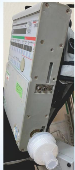
圖6 轉送型呼吸器，以LTV1000為例，機身正/側面觀
