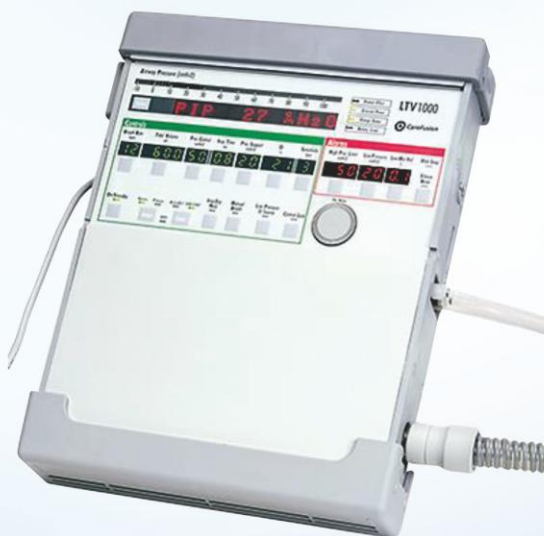
圖6 轉送型呼吸器，以LTV1000為例，機身正/側面觀
