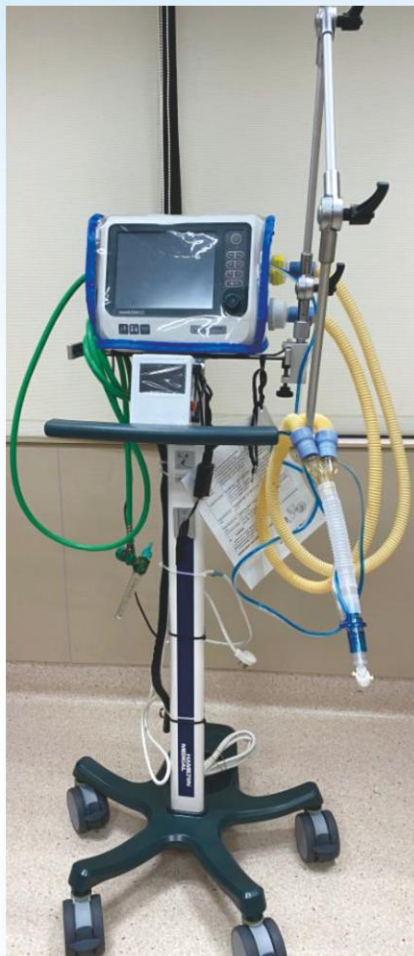
圖5 轉送型呼吸器，以Hamilton C1為例，管路套組全貌
