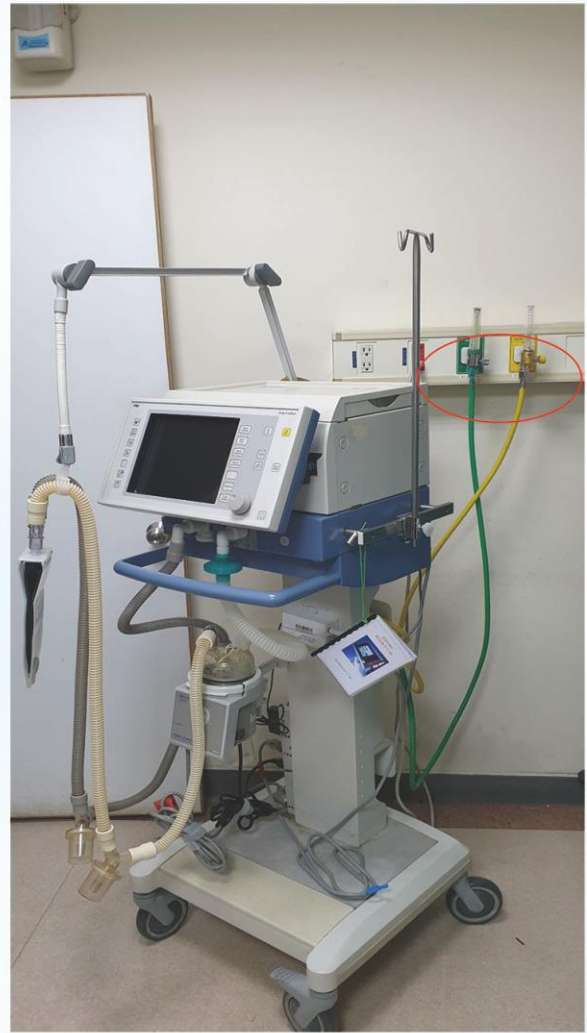
圖 5 中央高壓氧氣空氣氣體來源 (以 Drager Evita4 為例)
